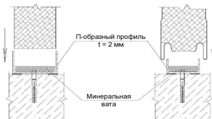
Рисунок Г.4 - Схема крепления к полу внутренних стен и перегородок из сэндвич панелей
