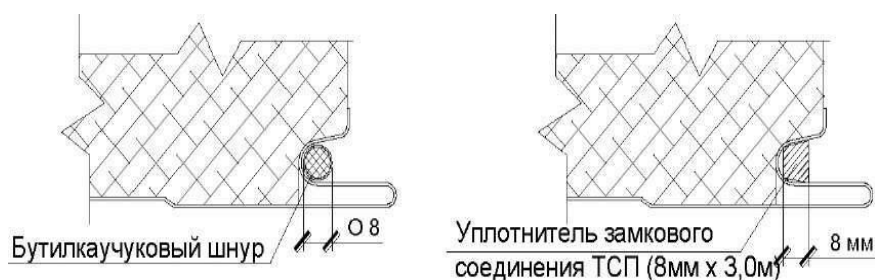
Рисунок Г.3 - Схема уплотнения зазоров стеновых сэндвич панелей
